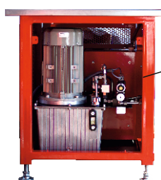
wbudowany zasilacz hydrauliczny o mocy 4 kW
